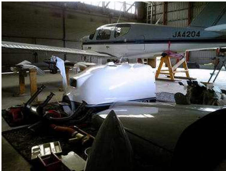
<エンジン交換作業中のソカタ>
