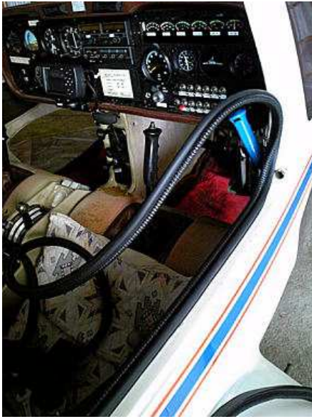
<左:ボロボロになったシールクッション部 右:交換中のトリムシール>
