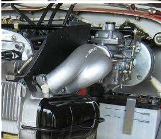
(左)今回変更した旧型インテーク・マニホールド (右)O/H New で付いてきた新型インテーク・マニホールド
