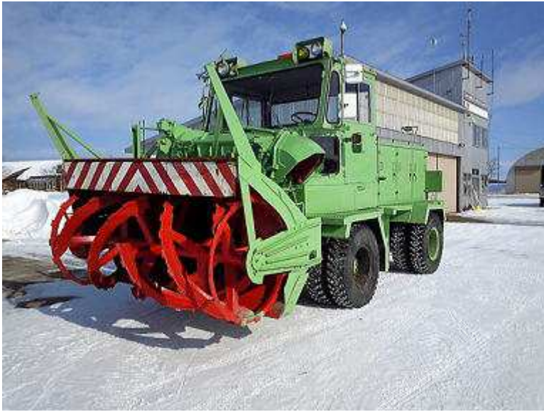
新たなロータリー除雪車。シュートが折り畳みできます。
